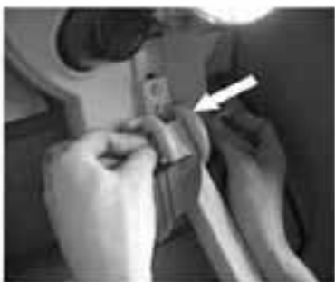
Stap 5 - Stel de bedieningshendel in en monteer de bevestigings- schroef.
